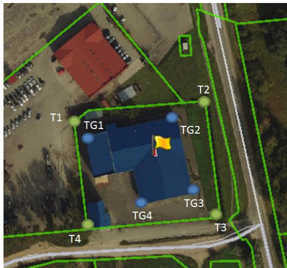
Pav. 19. Garso lygio matavimo taškai UAB Gonas: T1 – T4 – ties sklypo ribų; TG1 – TG4 – ties gamybos – sandėliavimo pastato ribų
