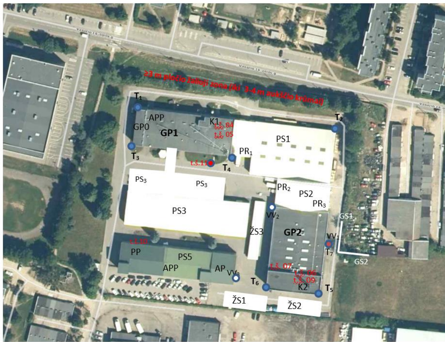
Pav. 21. Esami stacionarūs triukšmo šaltiniai (informacija, naudojama triukšmo modeliavimui)
