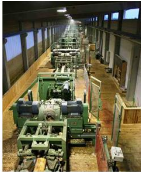
Technologinės linijos išdėstymo gamybiniame pastate pavyzdys
