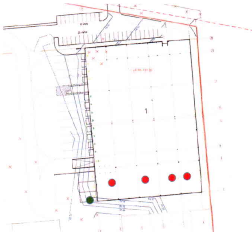
Pav. 2. Triukšmo šaltinių (ventiliacinių sistemų) išdėstymas gamybinio pastato išorėje (ant stogo)
