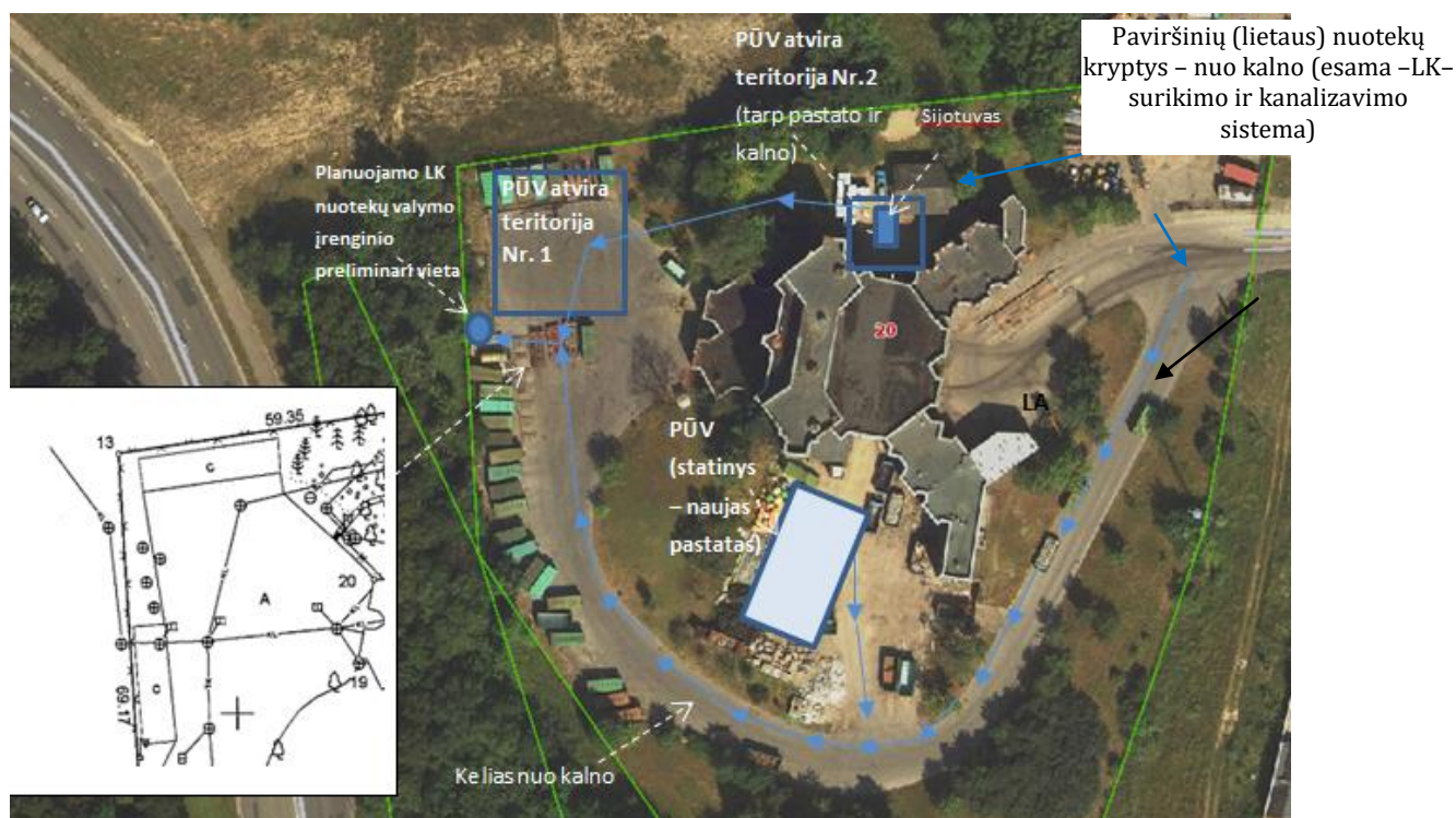
Pav. 17. Paviršinių (lietaus) nuotekų surinkimas ir planuojamo valymo įrenginio vieta (prieš išleidžiant į miesto nuotekų tinklus)
